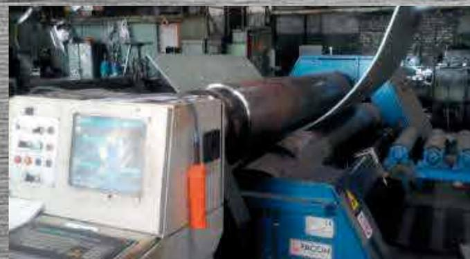
может быть использована для гибки листовой стали толщиной до 150 мм. Используется при загибе дна ковшей с одновременным снятием остаточных напряжений.
